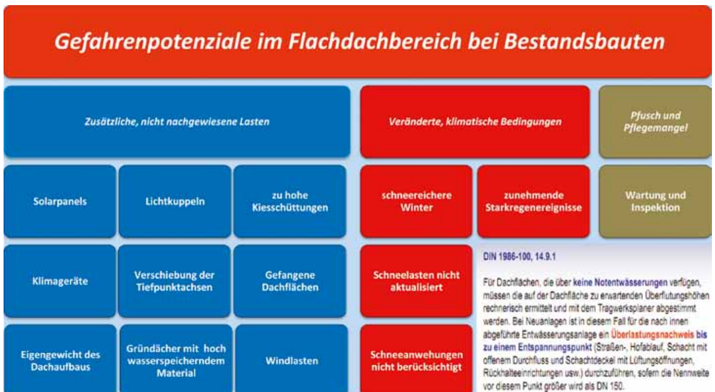
Überblick über Gefahrenpotenziale im Flachdachbereich von Bestandsgebäuden.
